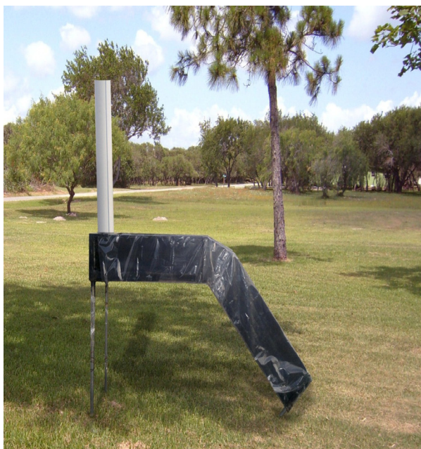
Рис. № 2. Конвективная гелиосушилка.
